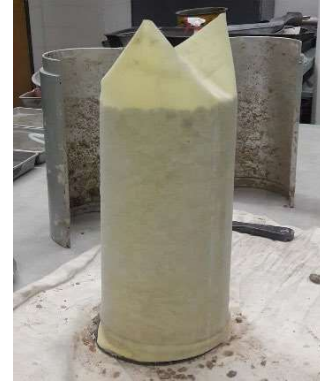
(d) specimen with rubber membrane
